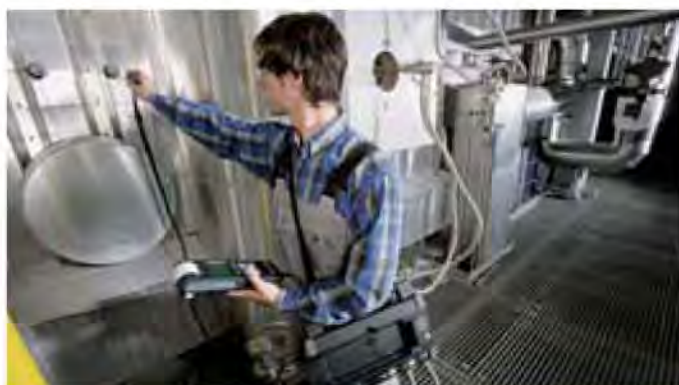
testo 350 XL: Kit standard per la misura su sistemi di processo (O 2 , CO, NO, NO 2 )
