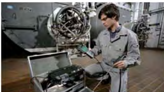
testo 350 S: Kit per il monitoraggio delle emissioni nei bruciatori industriali (O 2 , CO, NO)
