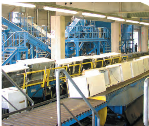
Figure: Le immagini mostrano dei particolari di uno dei più moderni impianti di riciclaggio di frigoriferi in Germania. Con la cortese autorizzazione della società RWE Umwelt AG, Grevenbroich.
