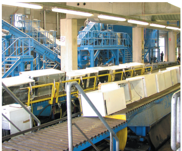
Figure: Le immagini mostrano dei particolari di uno dei più moderni impianti di riciclaggio di frigoriferi in Germania. Con la cortese autorizzazione della società RWE Umwelt AG, Grevenbroich.
